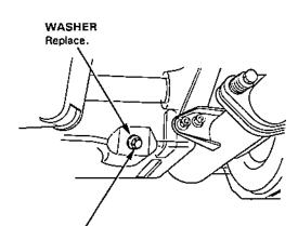
OIL PAN DRAIN PLUG 45 N·m (4.5 kg-m, 33 lb-ft)
